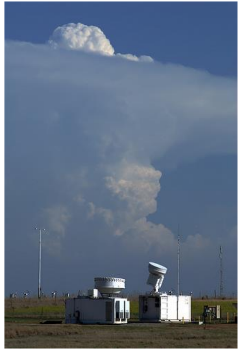
Radars nuage de 35 et 94 GHz (K a and W-band) colocalisés et à visée verticale
